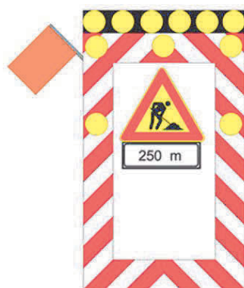
Figura 14: "segnale mobile di preavviso" derivato dalla fig. Il 400 Art.39 Reg. da impiegare per lavori sulla sola corsia di emergenza. E' integrato con set di 6 lampade a led ad alta efficienza luminosa diam. 300 mm (con possibilità di lampeggio sincrono e sequenziale) e con sbandiatore elettromeccanico posto in alto sul lato esposto al traffico.
