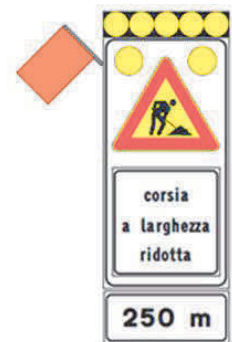
Figura 14: "segnale mobile di preavviso" derivato dalla fig. Il 400 Art.39 Reg. da impiegare per lavori sulla sola corsia di emergenza. E' integrato con set di 6 lampade a led ad alta efficienza luminosa diam. 300 mm (con possibilità di lampeggio sincrono e sequenziale) e con sbandiatore elettromeccanico posto in alto sul lato esposto al traffico.
